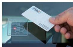
予約済みのクルマは赤いランプが点灯している。会員カードをかざすとドアロックが解除される仕組み。
